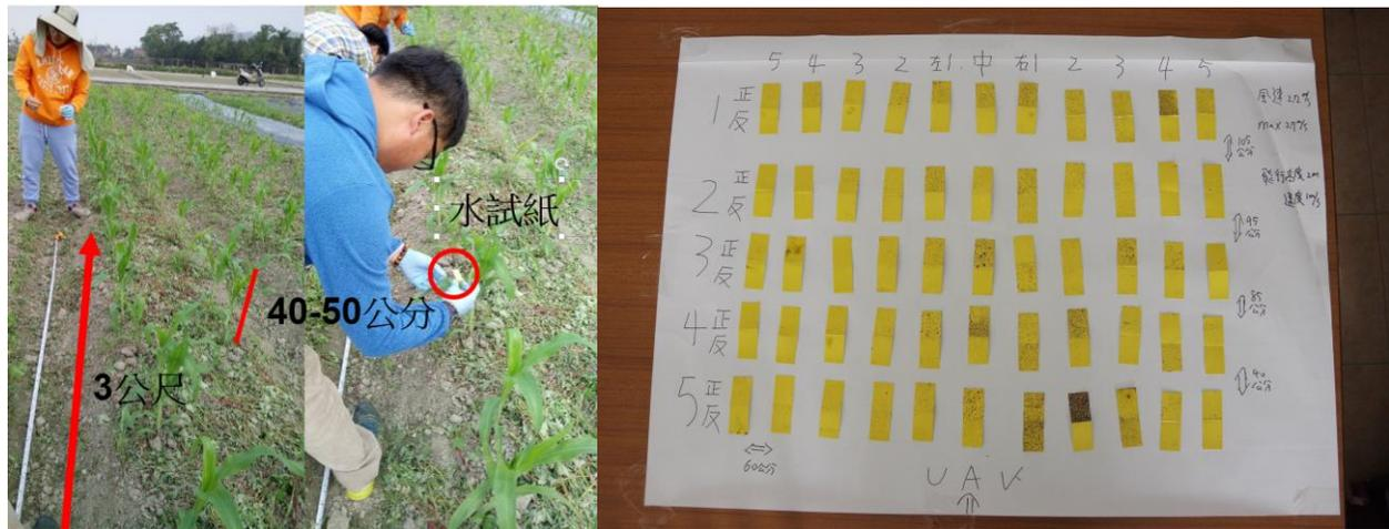
圖 7 農試所內試驗內玉米小苗噴藥試驗及水試紙分布位置及環境資訊
