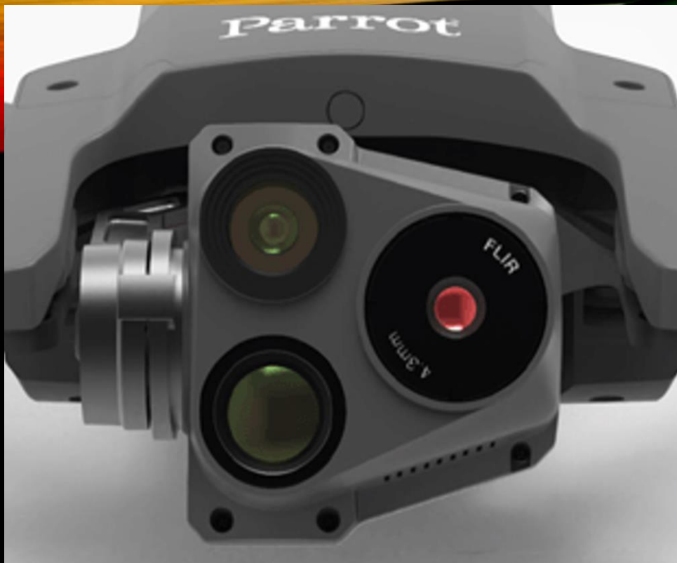
3軸穩定雲台 三鏡頭 (可見光+伸縮+熱影像)
