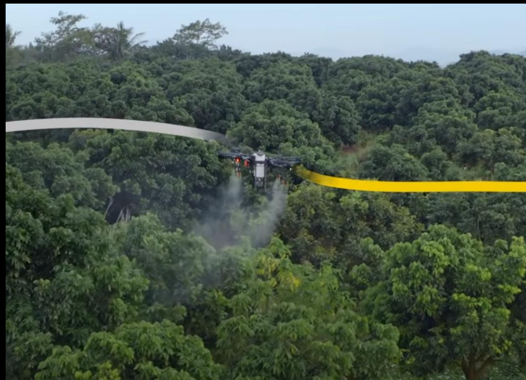
RTK植保機結合3維航線規劃執行等高度精準航線噴灑
