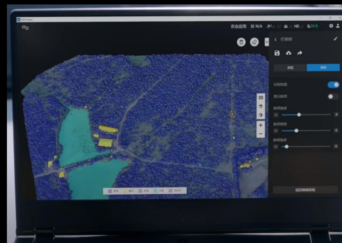
透過軟體後製針對植生區域進行3D模型建置及AI識別，自動標示果樹準確位置及高度
