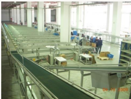
分流輸送設備
