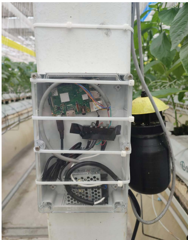
► 監測蟲桶之自動監測計數系統（資料來源：防檢署提供）
